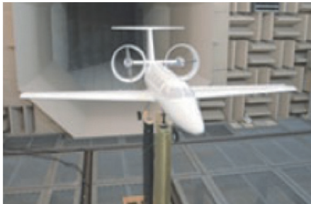
各種物体の空気力測定の例 (小型電動航空機サブスケール機)
