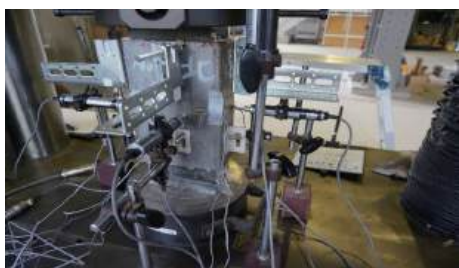
写真2 CFTの載荷実験
