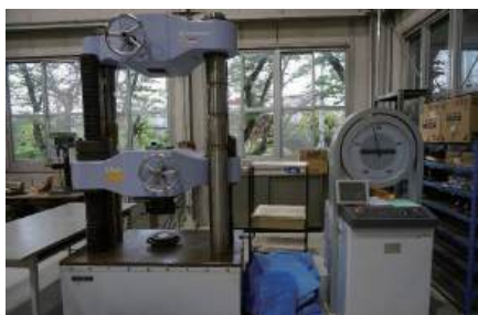
写真1 万能試験機の全容
