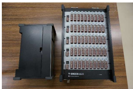
写真1 データロガーとスイッチボックス (TDS-540)
