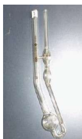
動粘度計 (キャノン フェンスケタイプ)
