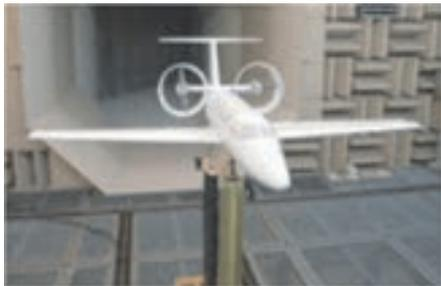
各種物体の空気力測定の例
