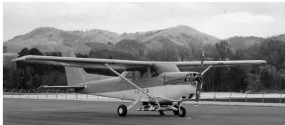
【写真1】電気モーターで加速するセスナ機
