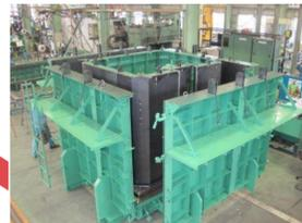
コンクリート型枠の例
