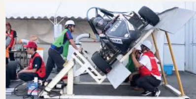
60度傾け、油漏れがないか確認。 上側タイヤが浮いたら失格
