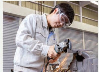
構成する部品や構造体の大部分を、学生自ら設計して造り上げるので、「部品を溶接する段階でも歪んだりするので、全体的な摺り合わせができていないと誤差を小さく抑えるのが難しいんです。」
