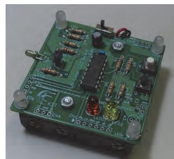
大学では特に Microchip 社の PIC マイコンを用いた様々な電子回路を開発しています。右の写真は加速度・角速度センサの情報をパソコンに無線で通信する装置で、動きに応じた家電制御や、スポーツのフォームチェックなどの活用を研究しています。一方左の写真は親子科学教室などでも使われているプログラミング教材です。PIC マイコンの中にバーチャルマシンを組み込み、簡単な自作言語で様々な色やパターンでの明滅を制御することができるものです。制御命令をパソコンディスプレイの明滅で教材に転送できることが特徴で、自宅の PC でもプログラムの作成・転送ができることから、その学習効果について研究しています。
